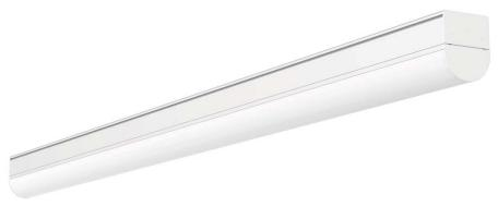
Sehr montagefreundliche Deckenleuchte, Gehäuse aus Metall weiss beschichtet. Diffusor aus Polycarbonat opal. Kleine Bauhöhe von 68 mm.Farbtemperatur sowie Leistung einstellbar mittels Switch, CRI 80. Sämtliche Typen mit Notlicht-element oder Dimmbar DALI lieferbar.
